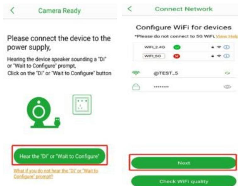
C. Seleccione la cámara Wi-Fi en la lista y agréguela (SSID::AP\_TST\_XXXXXXXXX); Esperando la configuración de red del dispositivo, después de los progresos de “Conexión WIFI”, “Conexión WIFI exitosa” “Cámara agregada”, la cámara está añadido con éxito Asigne un nombre al dispositivo y comience a experimentar.
